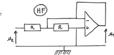
6. a) Comme  $i_+ = 0$ ,  $R$  et  $C$  forme un pont diviseur de tension donc :  $\boxed{V_+ = \frac{1}{1 + jRC\omega} V_A}$ .
