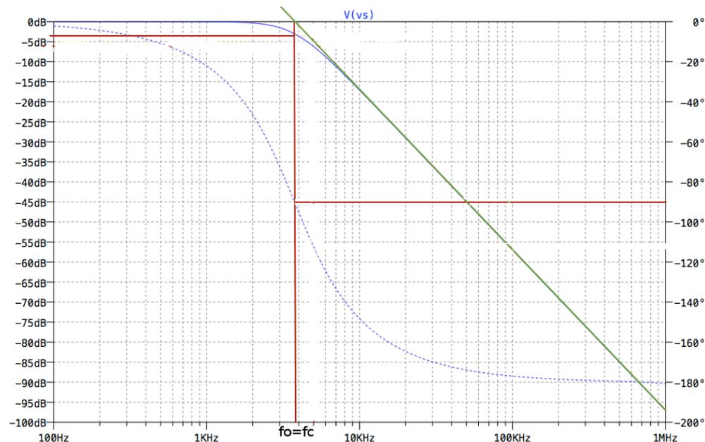
FIGURE 2 – Diagramme de Bode du filtre
